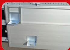
Hilfreiche Aufstiegstritte in den Bordwänden
