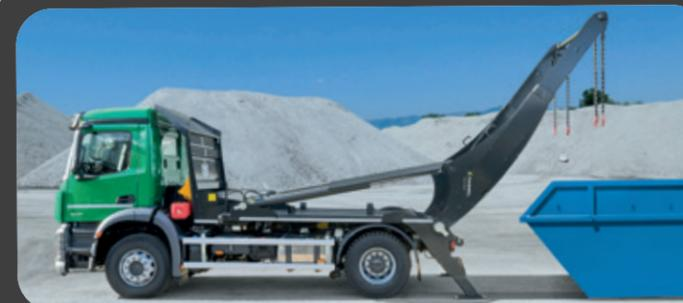
Die MARREL Absetzkipper zeichnen sich durch hochfeste Stähle, einen ausgereiften Herstellungsprozess, einfaches Design und einmalige Leistung aus. Die Absetzkipper sind mit 14 und 18 Tonnen Hubkraft erhältlich.
