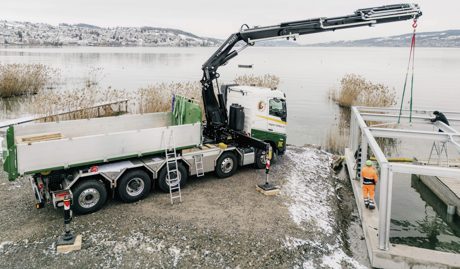
Kranarbeiten am Zürichsee: Konrad Hegner AG hat mit dem neuen Volvo FH500 mit Fassi-Kran und Marrel-Hakengerät von Notterkran schon einige Kranarbeiten verrichtet.
